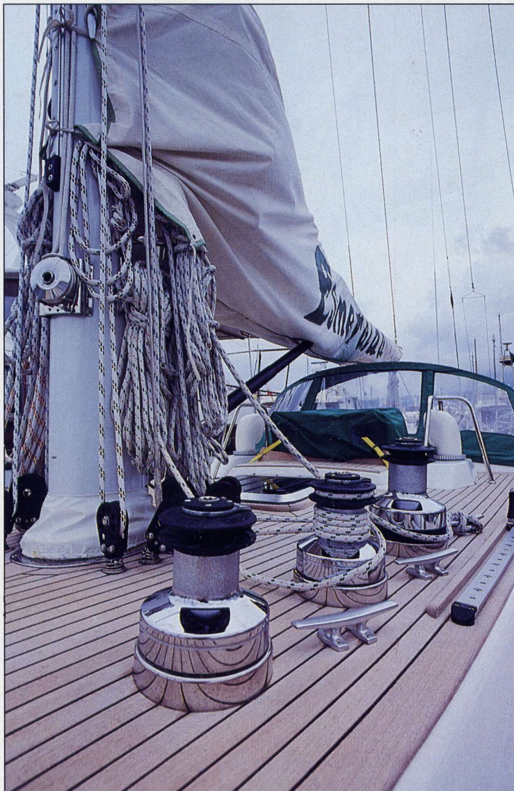
A destra, il piede d'albero con i numerosi winches per il controllo delle drizze. L'albero è Velscaf.
